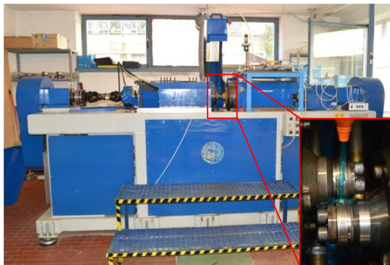
Figure II-2 Machine Bi-Disque de l'université de Brescia (Italie).
