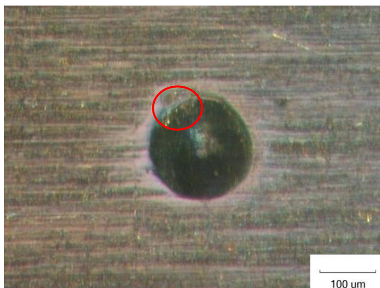
Figure II-12 Ingestion d'une particule en bord d'indent.
